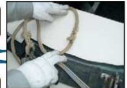
安全帯の点検 ※7
