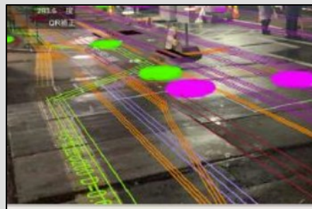
写真2 地下埋設物のAR表示
